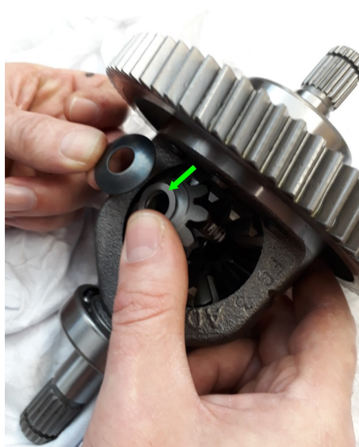
Bild 9: Einsetzen der Zusatzscheibe
