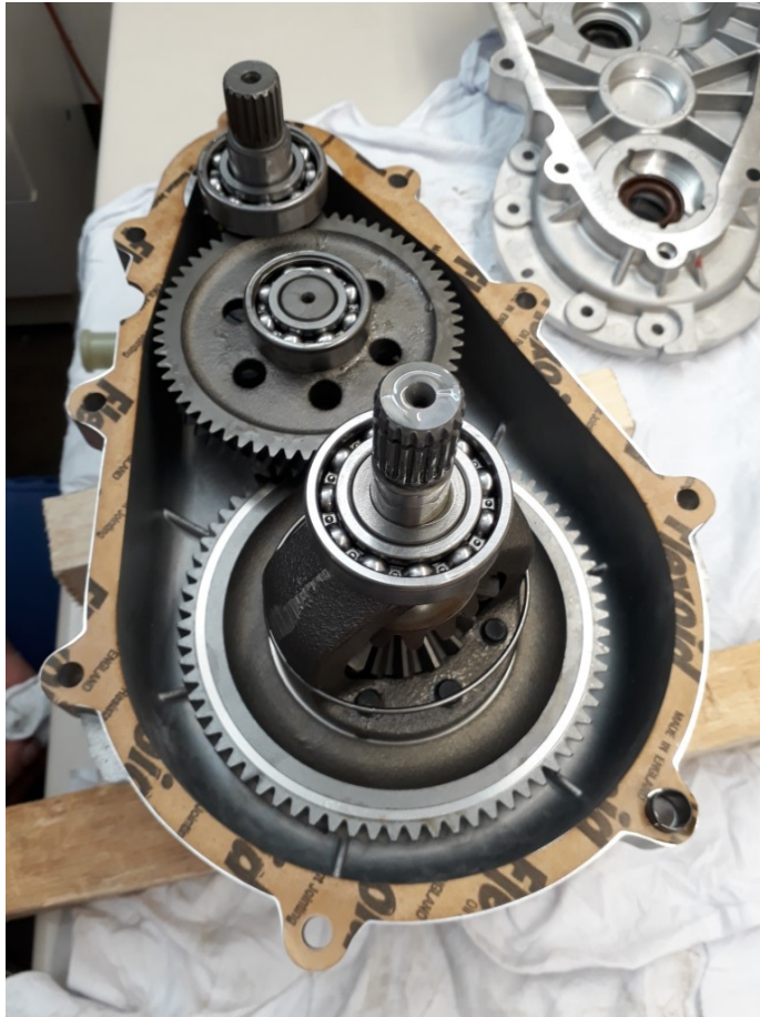
Bild 11: Getriebe mit bestückten Differential, Zwischenwelle und Ausgangswelle und neuer Dichtung.
