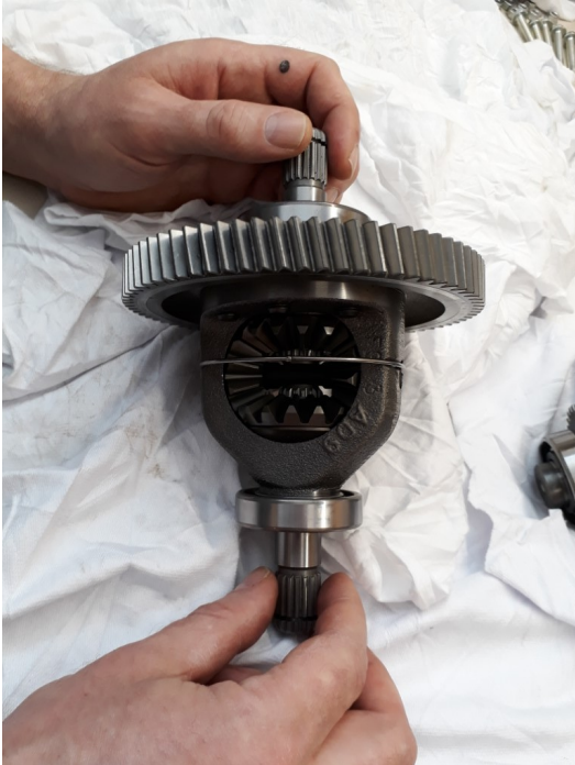
Bild 1: Differential nach Ausbau aus dem Getriebe
