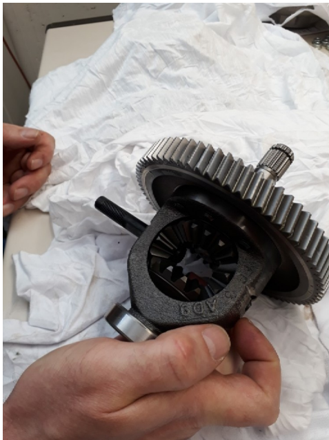
Bild 7: Welle zu einer Seite raus ziehen
