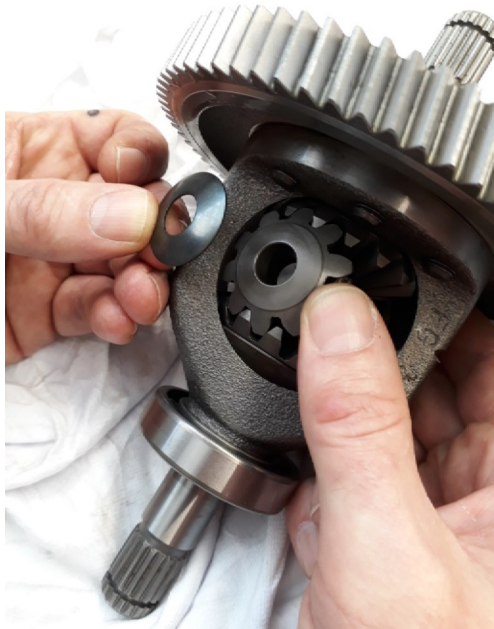
Bild 8: Kegelscheibe entnehmen
