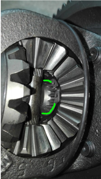
Bild 5: Seegerring einer Ausgangswelle.
