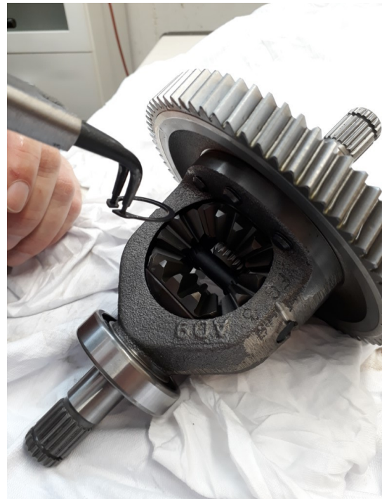
Bild 4: beide Seegerringe entnehmen (siehe auch Bild 5)
